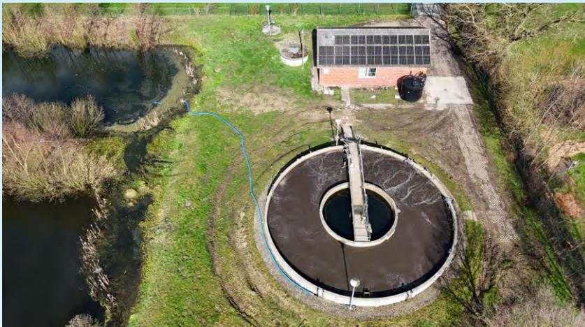
Als 2. Teil der Sanierungsarbeiten soll in diesem Jahr ein neuer Klärschlammbehälter mit rd. 100m<sup>3</sup> Volumen (gegenüber 30m<sup>3</sup> des bestehenden Behälters) gebaut und die mechanische Vorklärung erneuert werden.
